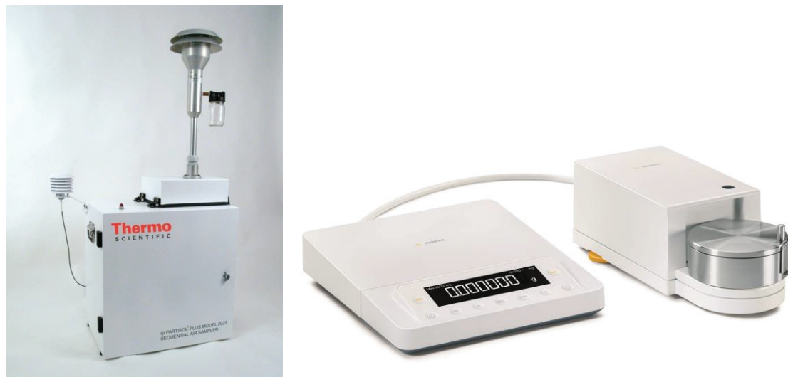
Figura 2: Equipamento de amostragem PM10 (à esquerda) e balança utilizada na pesagem dos filtros (à direita)
